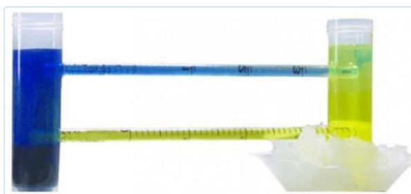
Modellen i bruk. Beholderen til høyre står i isbad, og fargen viser hvor vannet går. Foto: Sordalab.
