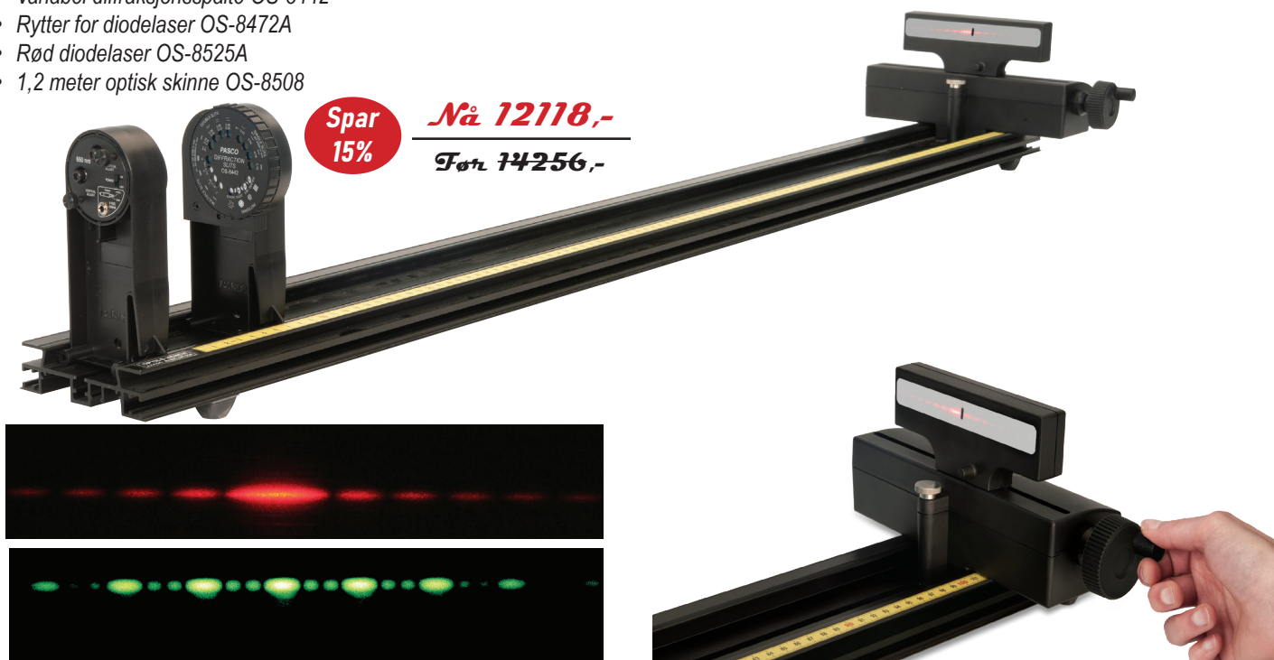
Diffraksjonsmønster fra 4 spalter, med henholdsvis grønn og rød laser.
