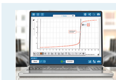
SPARKvue setter nå automatisk opp pH mot væskevolum. Klikk nå på væskevolum for å kalibrere dråpetellersensoren.
